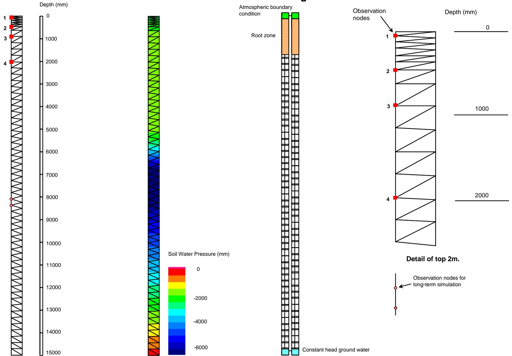
HYDRUS-2D Finite Element Mesh
